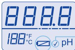
**Marca de comprobación indicadora de calibración exitosa**
